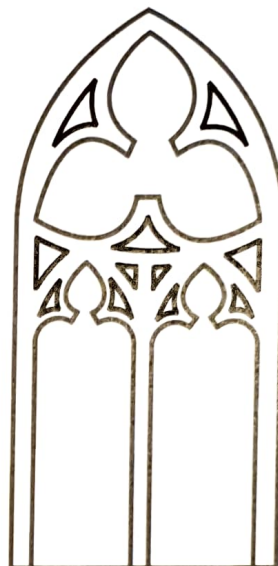
Il. 22. Próba rekonstrukcji maswerku z blendy trzeciej kondygnacji środkowej wieżyczki, wyk. M. Kurkowski
