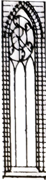
Il.17. Rekonstrukcja maswerku z blendy trzeciej od południa pierwszej kondygnacji środkowej wieżyczki, fot. za Cunym.
