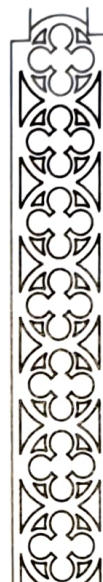
Il.28. Próba rekonstrukcji maswerku ze sterczyny drugiej kondygnacji ścianki parawanowej, wyk. M. Kurkowski
